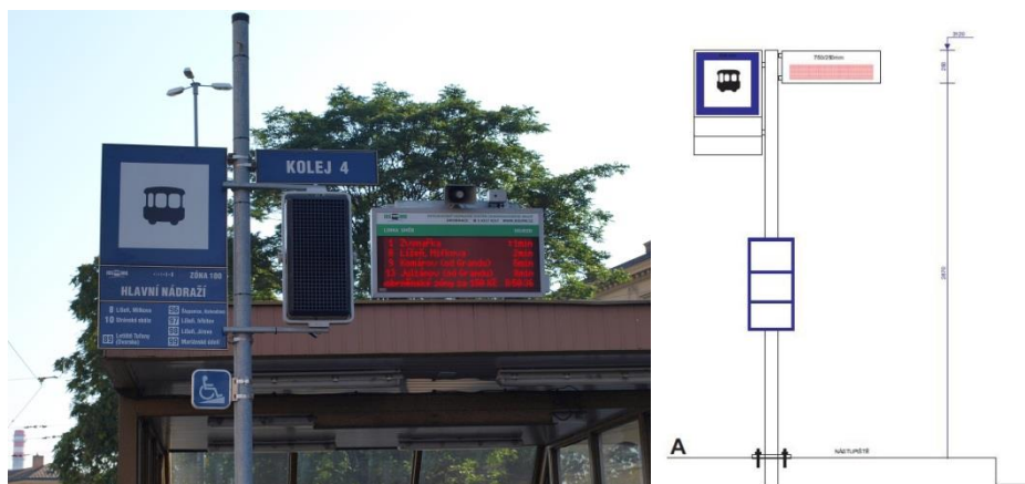
Obr. 2.6.12 Príklad na štandardizovaný označník zastávok v MHD Brno (IDS JMK) Zdroj: OMSI.cz, IDSJMK.cz
