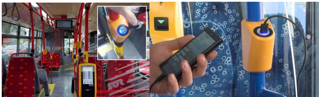
Obr. 2.6.13 Príklad na umiestnenie nabíjačiek mobilov vo vozidlách MHD (vľavo v MHD Bratislava) Zdroj: https://zn.sk/MHD-nabijanie-cez-usb-bratislava/ a batteryshop.sk
