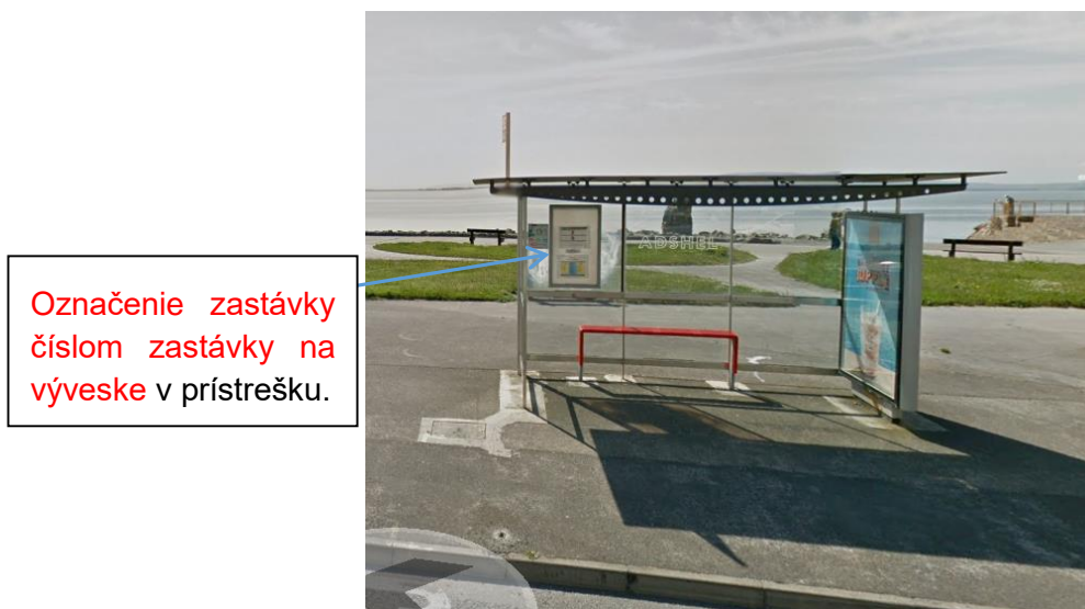
Obr. 2.6.11 Príklad označenia zastávok MHD vrátane čísla zastávky (Mesto Golway, Írsko) Zdroj: Spracované autormi na základe google.com/maps
